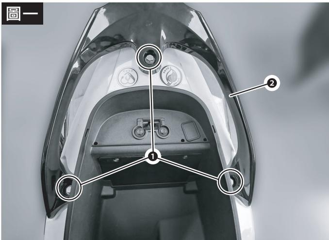
請使用適當工具，將**1**後扶手固定螺絲x3與**2**扶手拆下。
