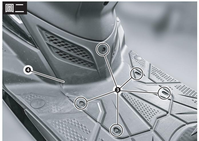
請使用適當工具，將**3**原廠胸蓋固定螺絲x5與**4**胸蓋下蓋拆下。
