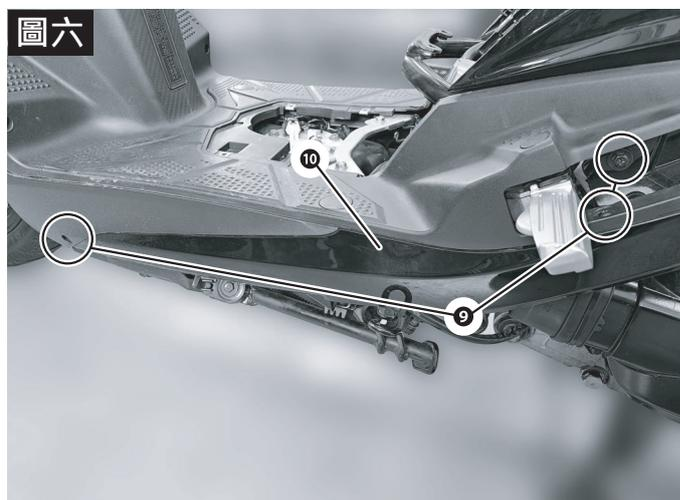
請使用適當工具，將**9**固定螺絲X6拆下，並取下**10**左、右側條。
