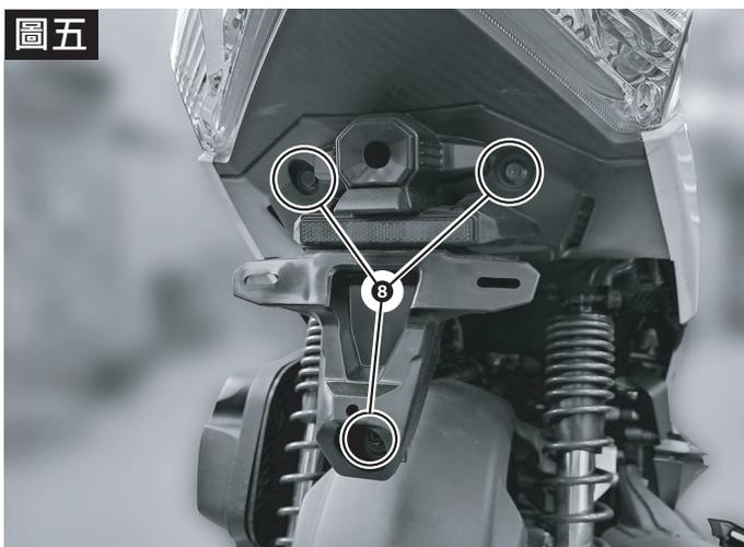
請使用適當工具，先拆下牌照板後，將**8**固定螺絲X3拆下。
