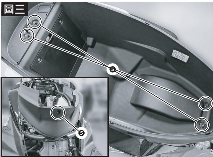
請使用適當工具，將**5**置物箱螺絲x5拆下，並取下置物箱總成。
