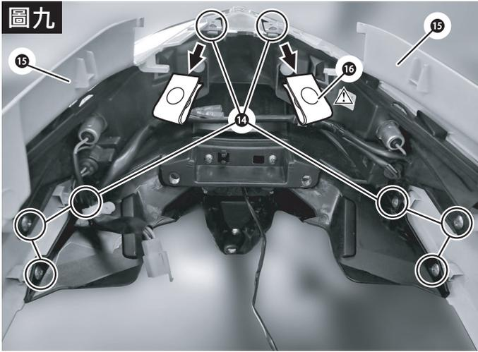
請使用適當工具，將⑭固定螺絲X8與⑮左、右側蓋拆下。
