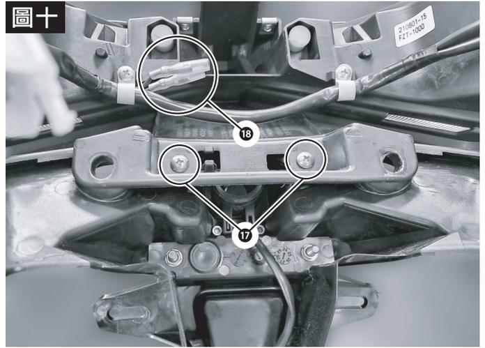
請使用適當工具，將⑰固定螺絲X2與⑱牌照燈接頭拆下，分離原廠後燈組及原廠後牌照架後，依照相反順序安裝KOSO 後燈。
