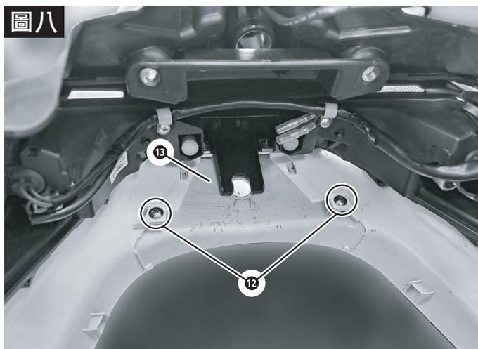
請使用適當工具，將**12**固定螺絲X2拆下與**13**尾燈上方護蓋拆下。
