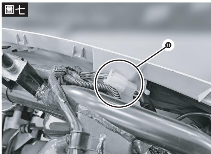
請將**11**後燈插頭、側殼與側條插扣拆下，並將側蓋尾燈及後牌架整組拆下。
