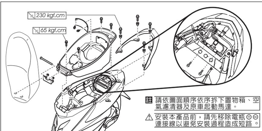
請依圖面順序依序拆下置物箱、空氣濾清器及原車起動馬達。
