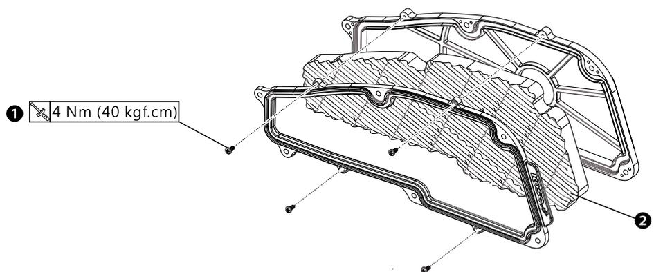
**⚠ 注意!** 更換濾綿時，新濾綿需確實放入框架之定位，以避免發生漏氣過濾不良之情形。
