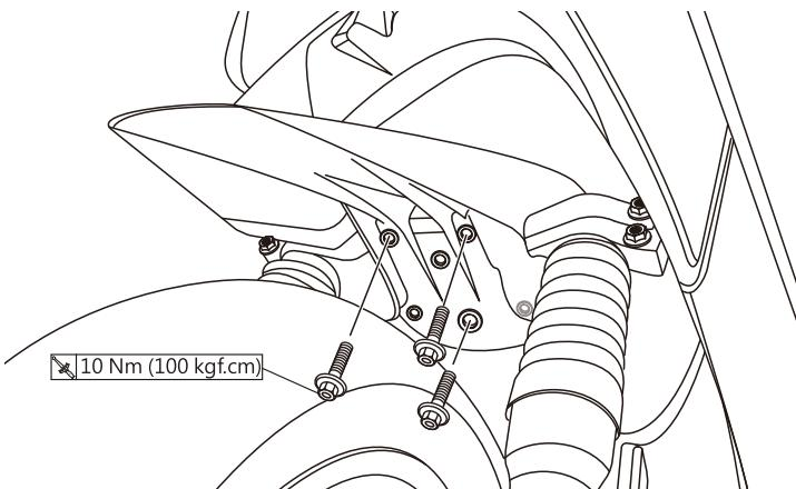
請使用適當工具，將原廠M6x20 mm螺絲X3拆下，並將KOSO 短版前土除(配件一)安裝至車上。
