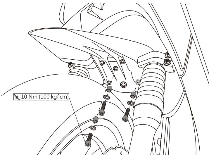
請使用適當工具，將原廠M6x20 mm螺絲X3拆下，並將KOSO 短版前土除(配件一)對準鎖孔，並使用適當工具，將M6x20 mm螺絲X3(配件2)、M6華司x3(配件3)與銅管x3(配件4)安裝至車上。
