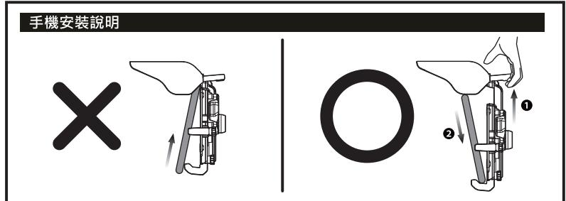
⚠ 注意！ 可用六角扳手來調整遮陽罩鬆緊度，螺絲建議鎖付扭力值為 $2.5\text{kgf}\cdot\text{cm}$  ( $0.245\text{N}\cdot\text{m}$ )  $\pm 0.5$ 。
