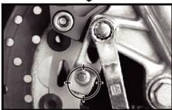
¡Ajuste la posición del soporte del sensor para asegurar que el sensor esté frente al imán y evitar una mala señal de velocidad o que no haya señal!
