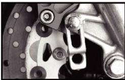
Instale el soporte tipo S de sensor.
