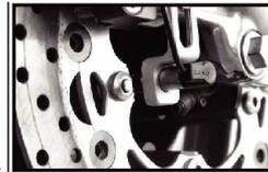
Instale el sensor de velocidad en el soporte.
