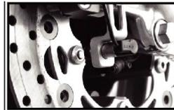
Installare il sensore di velocità sulla staffa.
