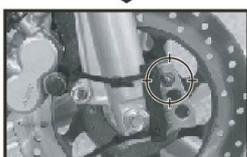
Usare la fascetta per fissare la staffa sulla forcella anteriore. Controllare che la vite disco venga inserita nel foro della staffa affinché sia possibile installare il sensore nello stesso foro per rilevare il segnale velocità.
