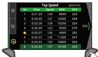
● Nel display registrazione velocità massima, premere il **tasto Regolazione** per entrare nel display di test.
