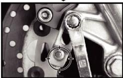
Regolare la posizione della staffa del sensore in modo che il sensore si trovi davanti al magnete per prevenire un segnale velocità di cattiva qualità.
