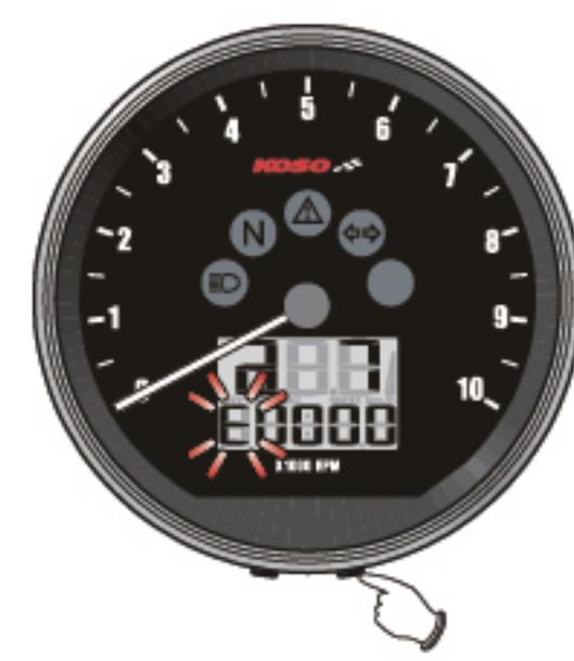
●按壓Select鍵5次，進入最高油量阻抗值自動偵測設定畫面。
