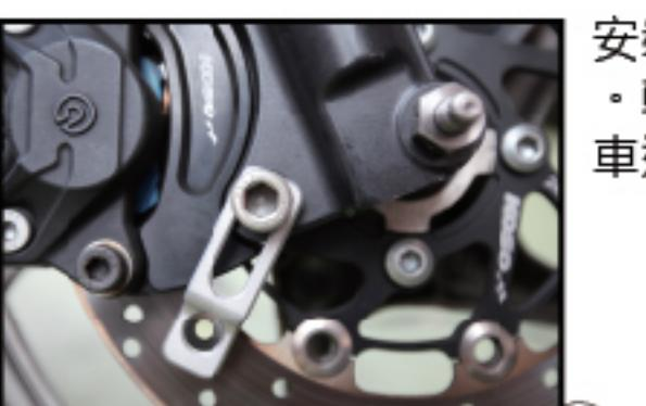
安裝S型轉接座，調整適當角度並旋緊固定螺絲。
