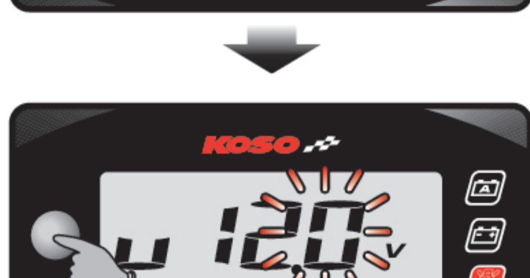
●圖例：低電壓警告由12.5V 設定為12V。
