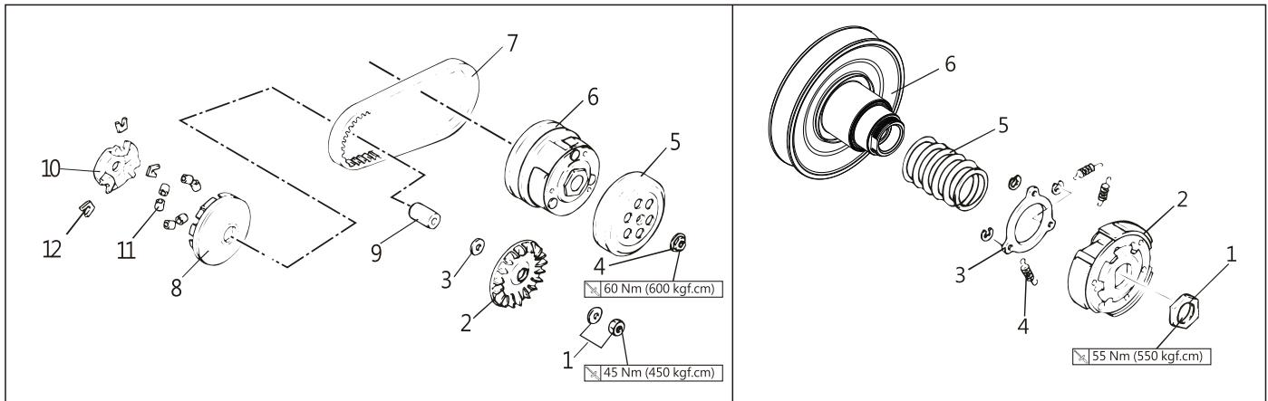
⚠ 注意! 請參照圖示順序進行拆卸作業。安裝時, 請依拆卸相反順序進行。
