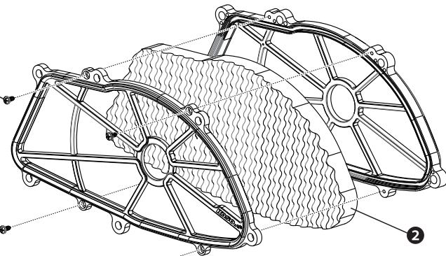
●放鬆四支螺絲①(配件4)，更換濾綿本體②，並放至定位，鎖上固定螺絲①(配件4)。
